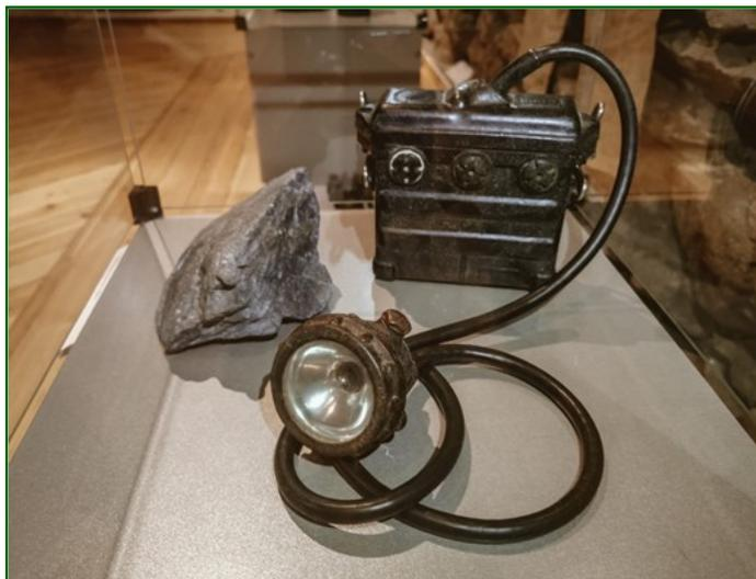
В конце XIX века появились электрические аккумуляторные лампы. Такие лампы регулярно совершенствовались. Они до сих пор применяются в горнодобывающей промышленности как надежный источник индивидуального освещения в сложных и опасных условиях шахт. Современные аккумуляторные лампы воплотили в себе мечты нескольких поколений шахтеров.
